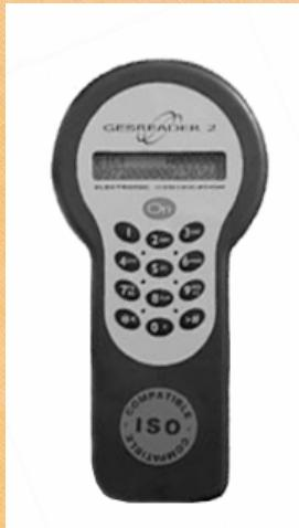
Conçu pour lire les puces RFID conformes aux normes européennes ISO pour l'identification électronique des animaux (ISO 11784 pour les lecteurs et ISO 11785 pour les puces)
